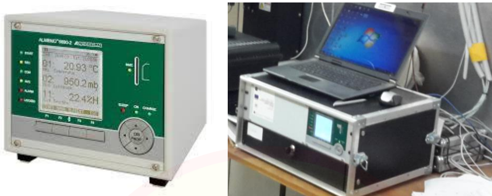
Obr.č.4 – meracia centrála detail a pohľad na pripojenú centrálu v systéme merania s riadiacim počítačom so zápisom dát.
