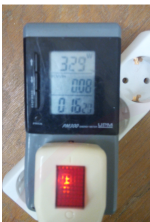
Obr.č.2 – elektromer PM300 s možnosťou odpočtu a zmeny meracích veličín
