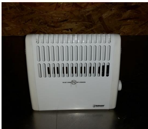
Obr.č.1B – elektrický konvektor = porovnávacía vzorka 102x295x250 mm.
