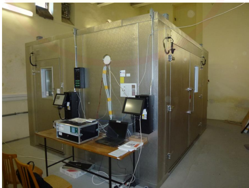
Obr.č.3 – pohľad na komoru Indoor stand s meracou centrálou
