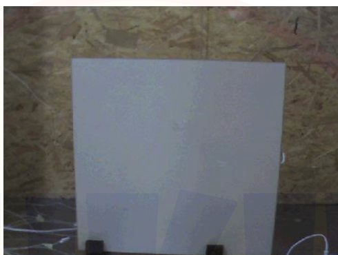
Obr.č.1A – elektrický sálavý panel = meraná vzorka 600x600x30 mm.
