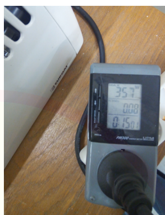
Obr.č.2 – elektromer PM300 s možnosťou odpočtu a zmeny meracích veličín
