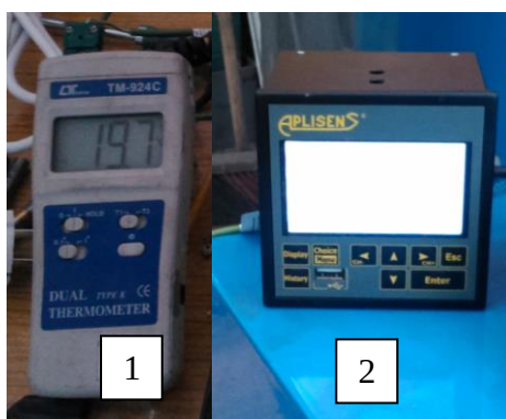
Fot. 5.1 Aparatura badawcza do pomiaru ilości wytworzonego ciepła i temperatury czynnika obiegowego
